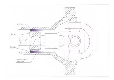
Elle nécessite une modification de l'arbre de roue et une modification de la trompette dans laquelle tourne l'arbre. Modification réversible, sans impacte mécanique sur les éléments modifiés, invisible extérieurement.
